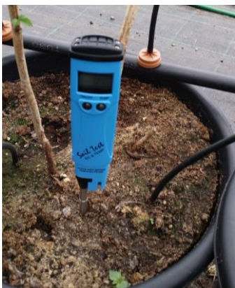
Figur 26. Ledningstalsmätare vid mätning i kruka.
