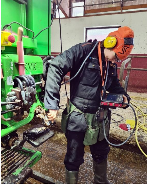
Mätning av sultjocklek med hjälp av ett portabelt ultraljud.
