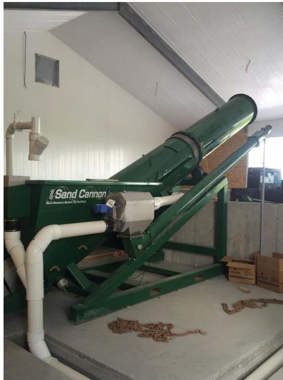
Figur 3. Sandcanon för sandåtervinning genom separation från gödsel. (Bildkälla: Dairy lane system)
