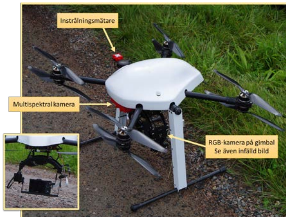
Figur 1. Utrustning för de drönrarna mätningarna. En multispektral kamera och en RGB-kamera monterades på en oktokofter.
