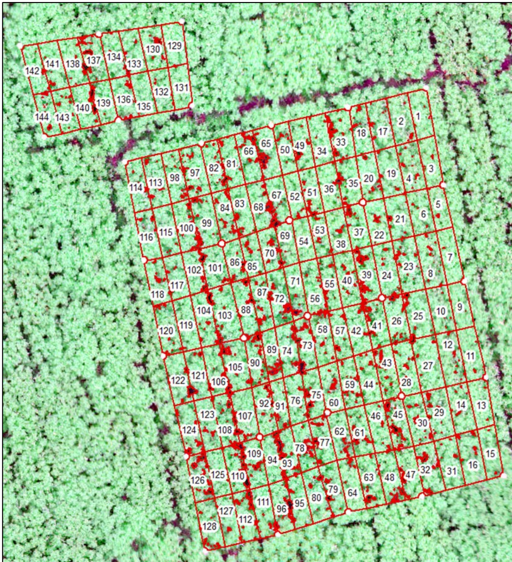
Figur 3. Översikt över observationsrutorna från mättillfället den 4:e augusti. Bakgrunden är en RGB-mosaik från fembandskameran med skuggor och mark bortmaskade (röd maskering). Pappallrikarna som markerade koordinatsystemet ses som vita cirklar. Rutornas storlek är omkring 0,75 \times 1,50 \text{ m}^2 (de varierar något beroende på utsättningsmetodiken).
