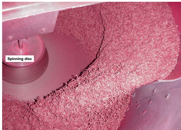
Inkrustering av dillfrö i Rotostat
